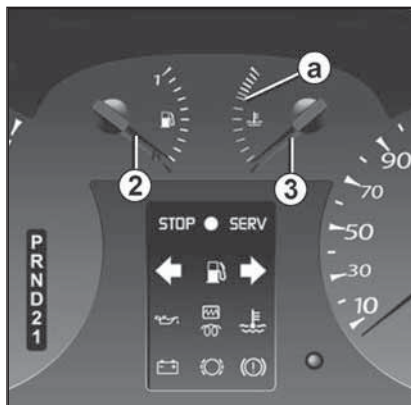
16.4 Указатели измерителей запаса топлива (2) и температуры охлаждающей жидкости (3)
