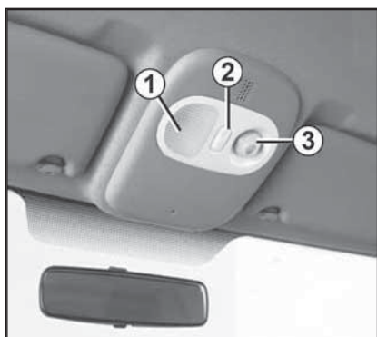
17.16 Передний потолочный светильник главного освещения салона
