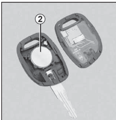
5.2 Детали установки элемента питания (2) ПДУ единого замка
