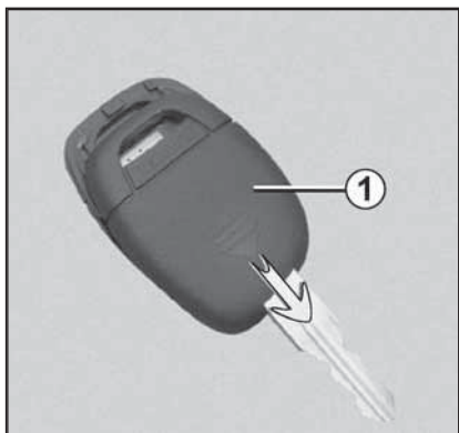
5.1 Снятие задней крышки (1) ПДУ единого замка
