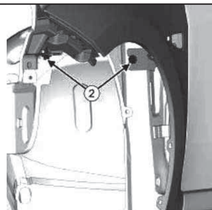
12.8а Детали установки переднего крыла (1 из 2)
