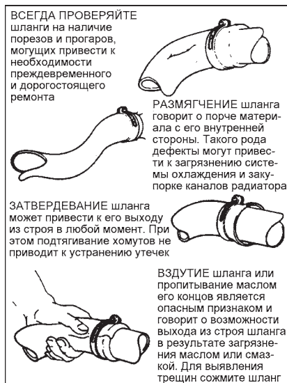
13.5 Наиболее типичные дефекты шлангов рабочего тракта системы охлаждения
