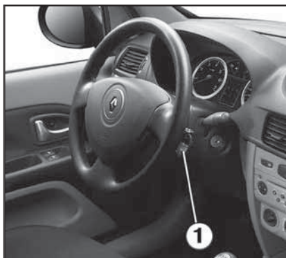
17.5 Местоположение дополнительного комбинированного подрулевого переключателя (1) с элементами дистанционного управления аудиосистемы (при соответствующей комплектации)
