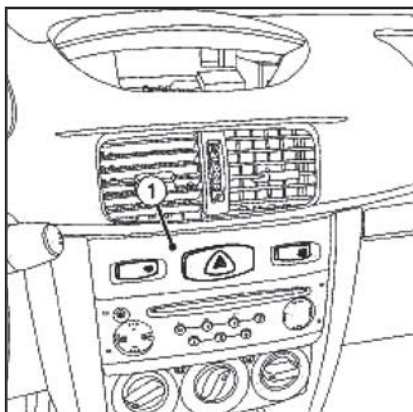
9.26 Для извлечения верхней панели (1) выключателей консольной секции панели приборов подденьте её монтажным клином Car. 1363
