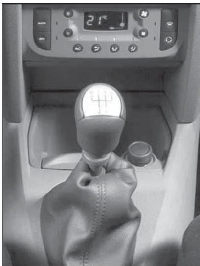
25.1 На торцевую поверхность рукоятки рычага РКПП нанесена схема переключения передач
