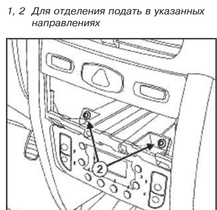
17.7 Порядок демонтажа рукава подачи воздуха в ножной колодец (на примере водительского)
