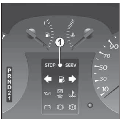
8.1 Местоположение контрольной лампы (1) иммобилайзера в комбинации приборов автомобиля
