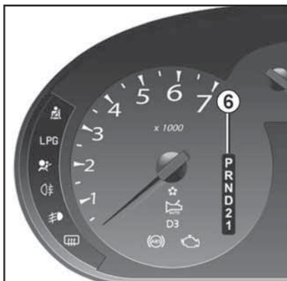
16.3 Местоположения индикатора (6) выбранного положения рычага селектора АТ (модели соответствующей комплектации)
