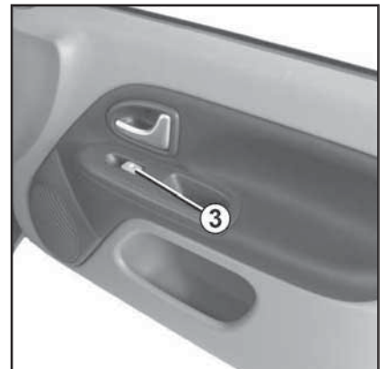
17.14 Индивидуальный переключатель (3) управления функционированием электропривода стеклоподъемника передней пассажирской
