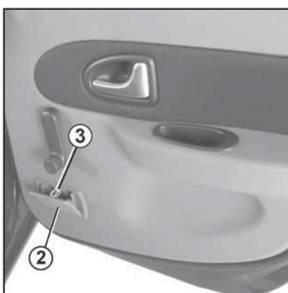
17.19 Откидные задние пепельницы (2) оборудованы в панелях внутренней отделки сборок задних дверей
