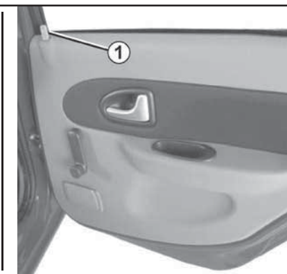
3.1 Местоположение выключателя дверного замка (3)
