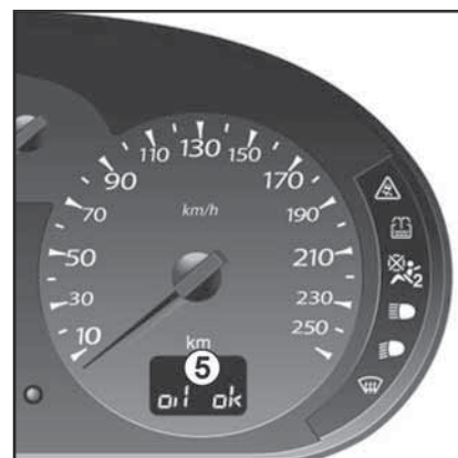
16.6 Местоположение ж/к экрана (5) путевого компьютера
