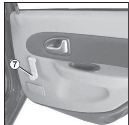
17.15 Коленчатая рукоятка (7) ручного привода стеклоподъемника задней двери (модели соответствующей комплектации)
