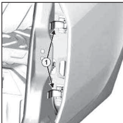
14.15a Регулировка положения штатных петельных сборок задних дверей в точках (1) осуществляется при помощи специальных приспособлений (См. 956 и Ms. 580)
