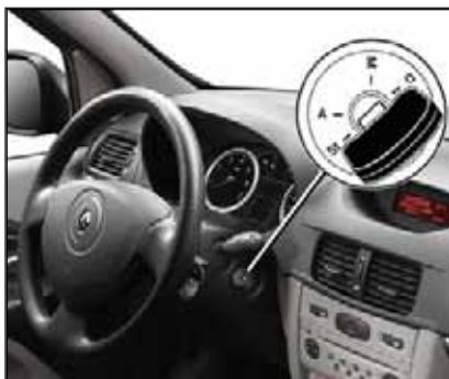
17.6 Выключатель зажигания/замок блокировки рулевой колонки
