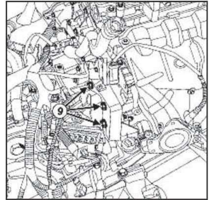
17.12 Болты (9) крепления стартера
