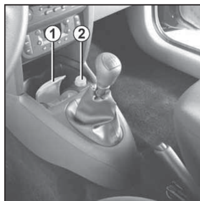
17.18 Местоположение прикуривателя (2) и передней пепельницы (1)
