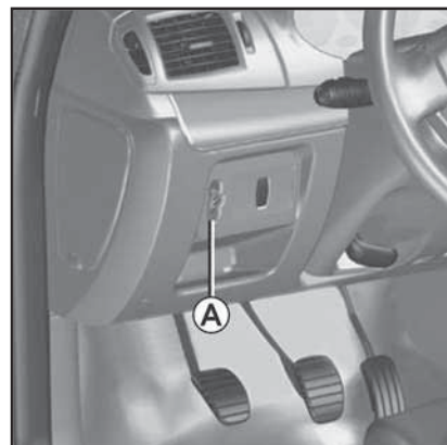
17.6 Выключатель зажигания/замок блокировки рулевой колонки
