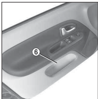
17.23 Небольшие лотки (6) под хранение мелких предметов встроены дверные подлокотники (на примере водительской двери)
