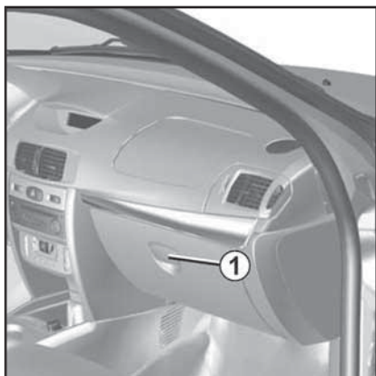
17.21 Для открывания главного вещевого ящика потяните на себя ручку (1) отпуская фиксатор
